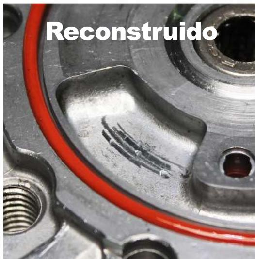
⚠ Si no se remanufactura adecuadamente, las superficies desgastadas continuarán generando residuos y pueden causar daños permanentes al sistema de dirección.
